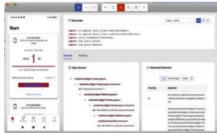
Screenshot Appium: Hier Appium-Inspektor mit laufender Skriptaufnahme. Links die Ansicht wie auf dem angeschlossenen Gerät, rechts oben die Ansicht des aufgezeichneten Skriptes.
